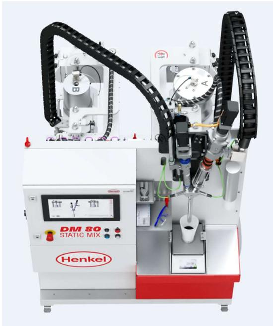
Die Dosiermaschine Sonderhoff DM80 Static Mix mit Mischkopf und integrierter Präzisionswaage zur permanenten Kontrollverwiegung bei Kalibrierung und Dosierung.
