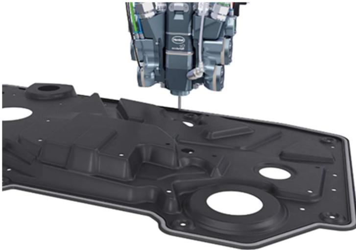
Der vollautomatische Dosierauftrag gemäß der FIPFG-Technologie erfolgt mit dem CNC-gesteuerten Präzisionsmischkopf MK 825 PRO und der Dosieranlage DM502 mit hoher Dosiergenauigkeit.
